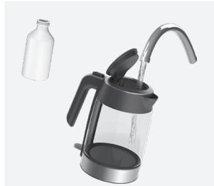
3. En iyi performans için üç ayda bir kireçlerin temizlenmesi tavsiye edilir. Kireç çözücü ürün talimatlarına uygun şekilde su ısıtıcısu ve kireç çözücü ile doldurun. Suyu kaynatmayın, köpürüp taşabilir. **Arından**, su ısıtıcıyı taze su ile iyice yıkayın.
