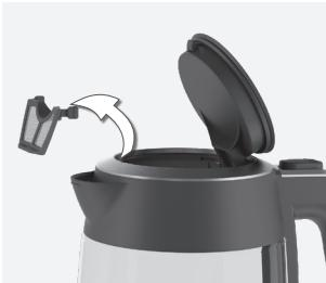
2. Ağ filtresini temizlemek için önce bir tarafta ve ardından diğer tarafta yavaşa bastırarak filtreyi su ısıtıcısı gövdesinden çıkarın. Tekrar yerine takmak için önce alt kısmını yuva yerleştirin ve ardından üst kısmı yavaşa bastırarak ilgili yuvalara yerleşmesini sağlayın.
